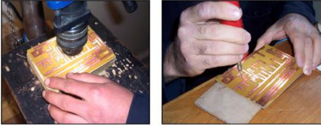
Resim 3.2: Baskı devre plaketi üzerine yerleştirilecek elemanların bacak yerlerinin delinmesi
