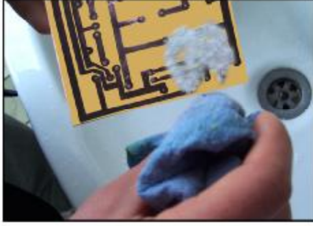
Resim 2.3: Asit çözeltilisinden sonra baskı devre plaketin temizlenmesi ve baskı devrenin son hali
