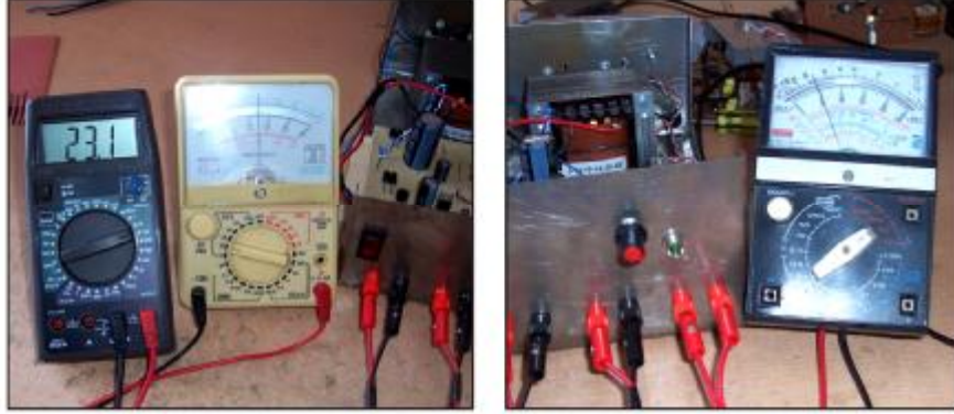
Resim 5.1: Güç kaynağının çıkış gerilimlerinin ölçülmesi
