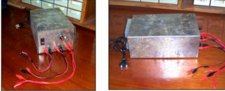
Resim 5.4: Güç kaynağının kutulanmış hali
