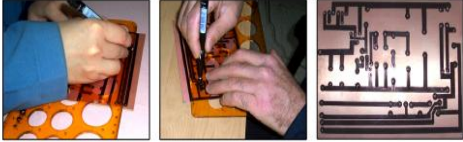
Resim 2.1: Güç kaynağının plakete çizilmesi
