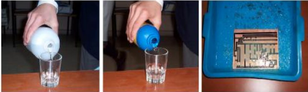
Resim 2.2: Gerekli asit çözeltisinin hazırlanması ve baskı devrenin asit çözeltisine atılması
