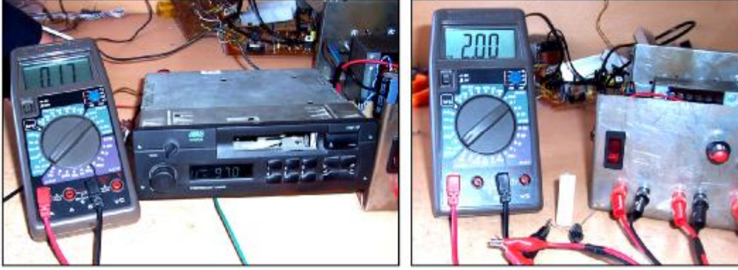
Resim 5.3: Güç kaynağından çekilen akımın ölçülmesi
