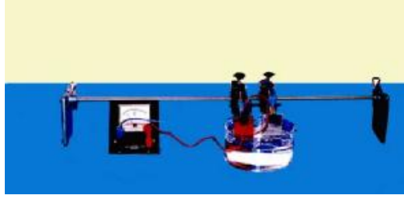
Resim 2.6: Sıvı çözeltili bir pil (volta pili) uygulaması
