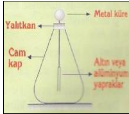
Şekil 1.33: Yapraklı elektroskop resmi ve yapısı
