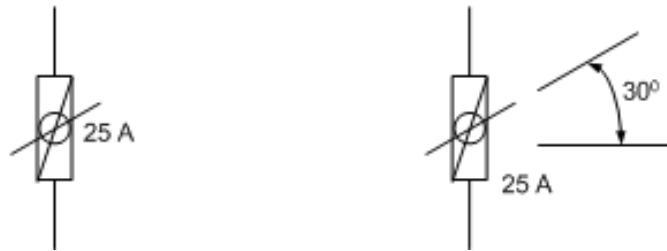
Şekil 1.6: Kapalı devre çiziminde sembollerin gösterim standardı
