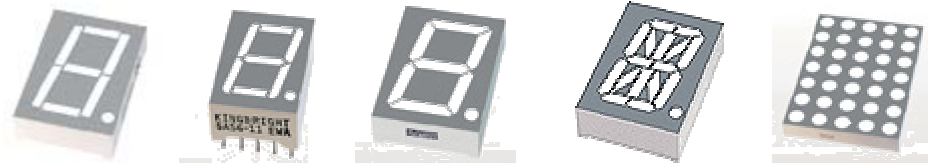
Şekil-3.23 Led göstergenin temel yapısı ve tipik görüntüleri
