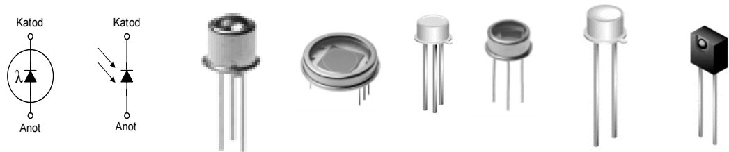
Şekil-3.25 Foto-Diyot’un şematik gösterimleri ve görüntüleri
