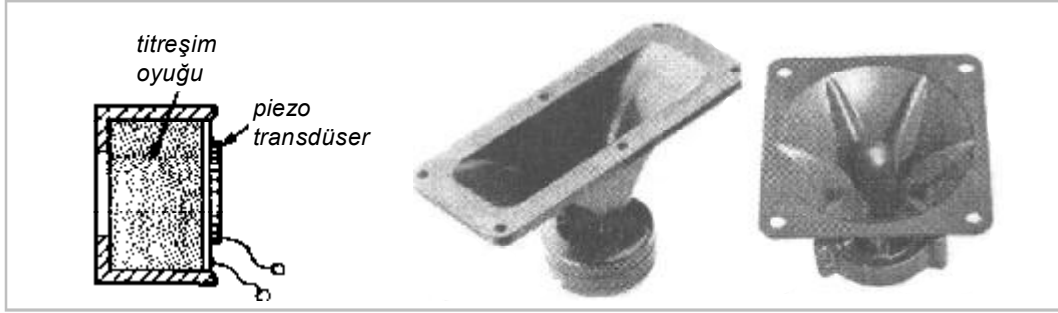
Resim 7.8: Piezoelektrik (kristal) hoparlörlerin yapısı ve kristal hoparlör örnekleri
