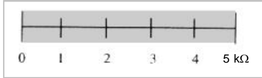
Şekil 1.14: Lineer potansiyometrelerde direncin değişim aralıkları
