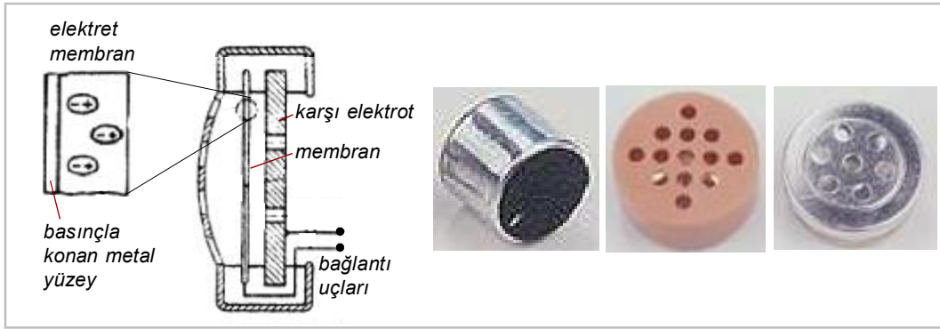
Şekil 7.7: Elektret mikrofonun iç yapısı
