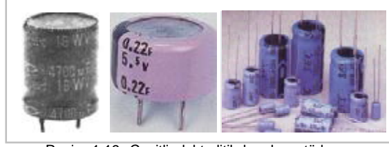
Resim 1.19: Çeşitli elektrolitik kondansatörler
